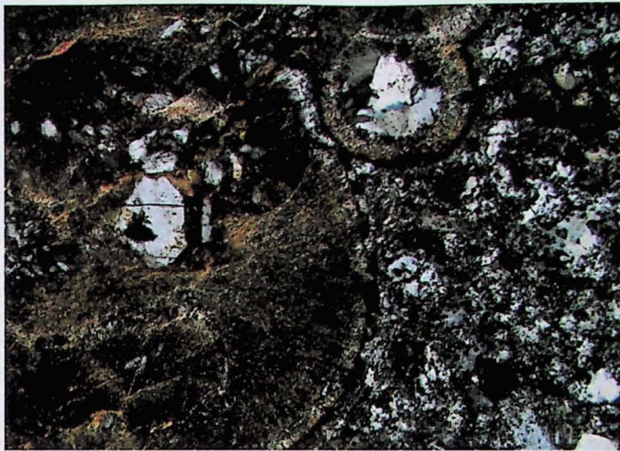
Foto 6: Detalhe de um lapilli -tufo acrescionário com esferulitos (Amostra 21Bb, lado maior da foto = 1,3 mm, com polarizadores cruzados)
